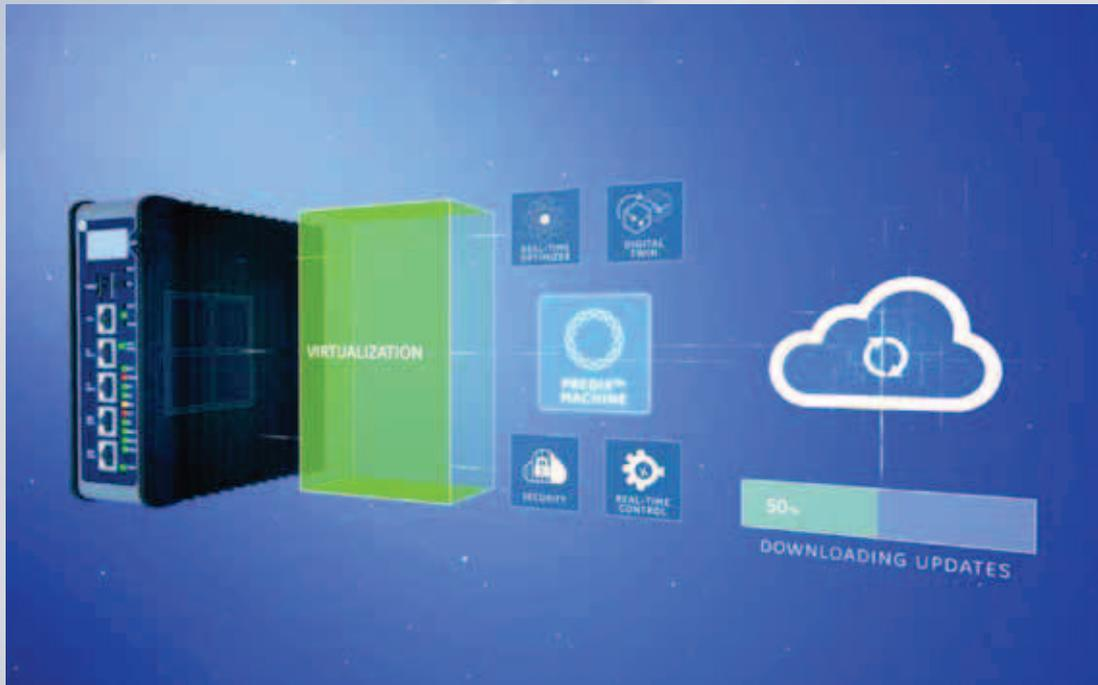
Beim Industrial Internet Control System (IICS) wird die Cloud entlastet, weil ein **Teil der Datenverarbeitung bereits auf der Maschinen- oder Anlagenebene passiert**. Das beschleunigt die Analyseprozesse. Die handelnden Personen können somit schneller die „richtigen Schlüsse“ ziehen.
