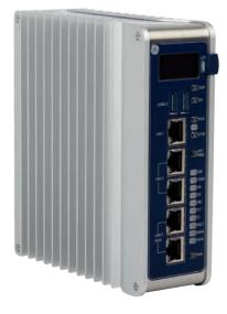
links Die Field Agents lassen sich über unterschiedlichste Schnittstellen sehr einfach in bestehende Produktionslandschaften integrieren und fungieren als sichere Gateways zwischen OT-Ebene und Cloud.
